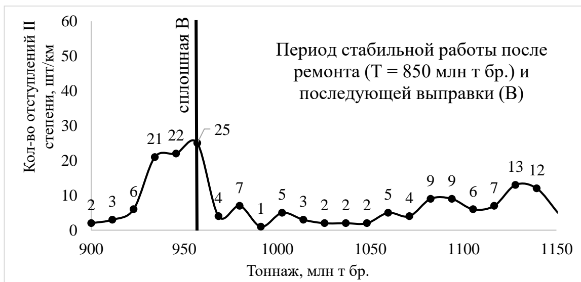
Рисунок 2.6 – Распределение количества отступлений II степени в функции прошедшего тоннажа на 1004 км 1 пути направления Киров-Екатеринбург с наработкой до 1190 млн т бр. (В – выправка)
